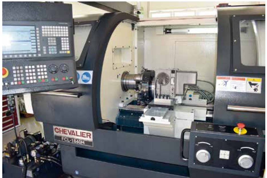
Die Chevalier FCL-1840H bei Müller-Mechanik ist mit einem 8-fach-Revolver und hydraulischem Spannfutter ausgerüstet
