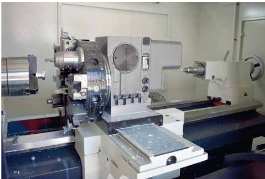
Gut zu erkennen: Bei der FCL-1840H versprechen Führungsbahnen und Querschieber einiges an Stabilität
