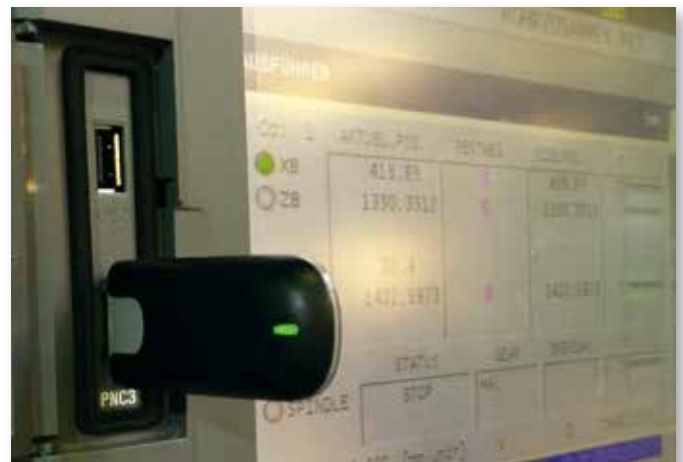
Zur Ferndiagnose einfach UMTS-Stick in vorhandenen USB-Anschluss stecken.
